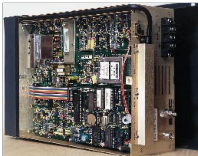
Blick auf die Oberseite des geöffneten Transceivers. Rechts in der Mitte der Quarz-Thermostat für die Referenzfrequenz von 11,940 MHz, darunter die DSP-Baugruppe.
