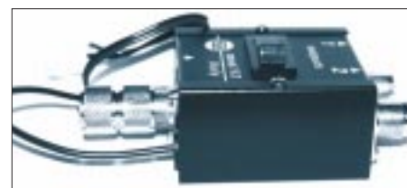
Bild 3: Für die mechanische Konstruktion der Umschalteneinrichtung findet ein allseits geschlossenes Metallgehäuse Verwendung.
