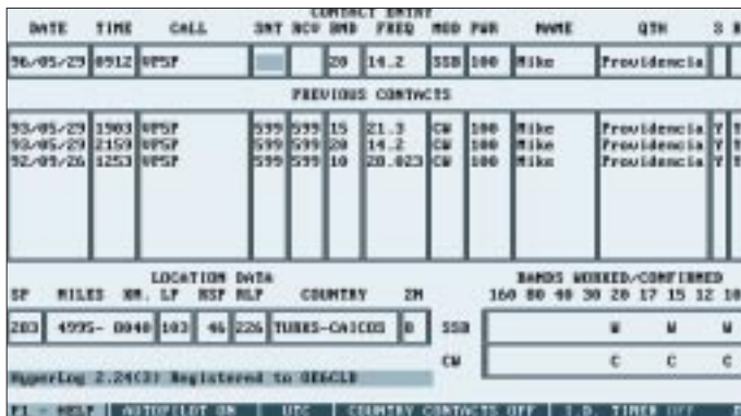
Bild 39: Der Hauptbildschirm von Hyperlog. Das obere Fenster dient zur QSO-Eingabe, das mittlere zeigt frühere Kontakte mit dem aktuellen QSO-Partner oder Präfix usw., das unten links Daten zum Land des Partners und das unten rechts den QSL-Status dieses Landes.
