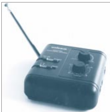
Bild 1: Verwendet für dieses Projekt: Unicom, eine selektive Aktivantenne der Firma Westfalia Technica.
