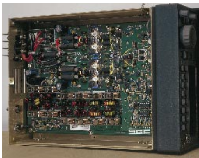
Die Unterseite des Geräteinneren zeigt, wiederum sehr sauber aufgebaut, im wesentlichen die Senderendstufe mit den umschaltbaren Tiefpaßfiltern zur Oberwellenunterdrückung. Fotos: DK8OK
