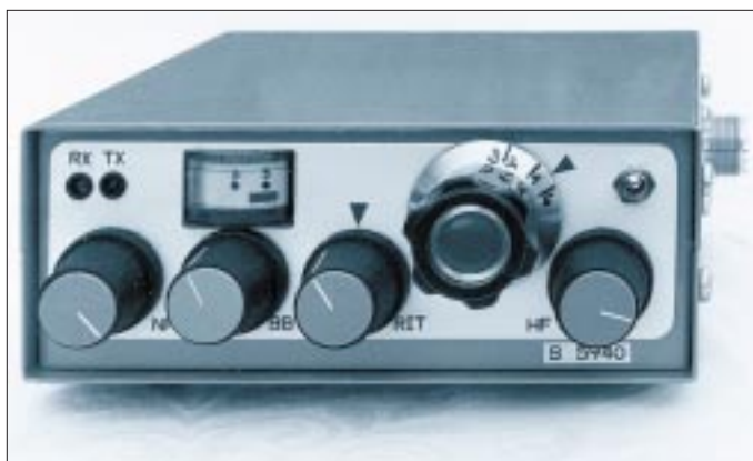
Bild 12: Gesamtansicht des S 5940. Mit dem kleinen Schalter läßt sich die Beleuchtung des Meßinstrumentes einschalten.
