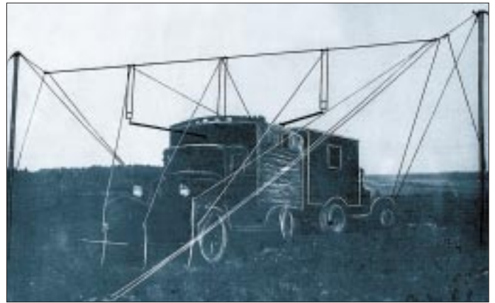
Erste sowjetische Funkmeßstation RUS-1 (Empfangsanlage) aus dem Jahr 1939.
