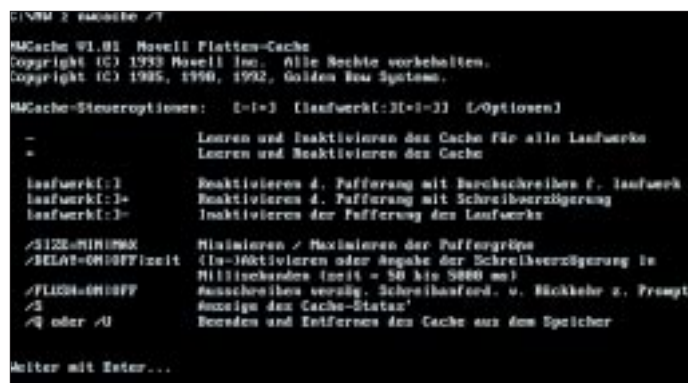
▲ Bild 7: Novell Cache: Mit dem Parameter /? verschaffen Sie sich schnellen Überblick über die Parameter.
